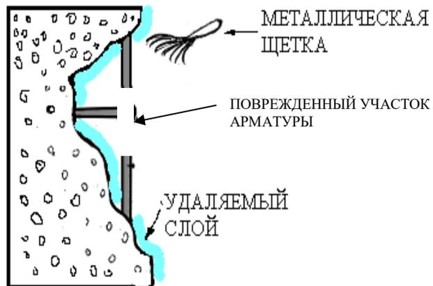
Рис. 1.1. Удаление поврежденного слоя бетона
