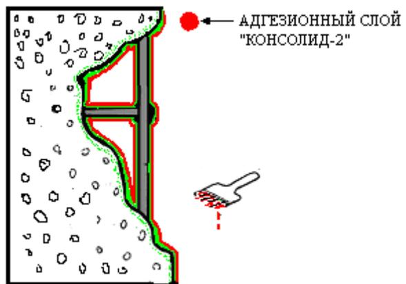
Рис. 3.1. Нанесение адгезионного слоя
